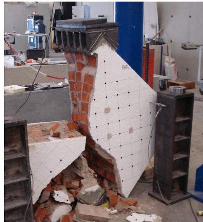
Quadro fessurativo del pannello “R\_VETRO” al termine della prova (lato anteriore)
