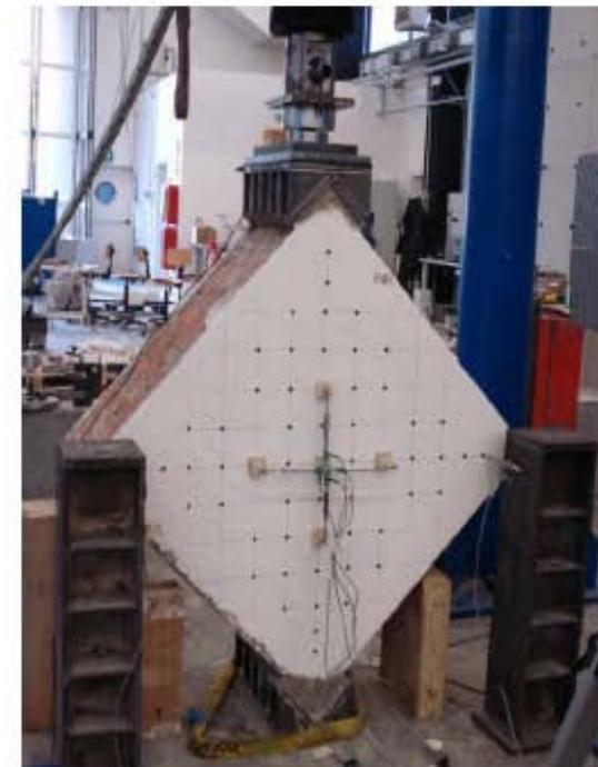
Determinazioni e misure per compressione diagonale su muratura con intonacatura di malta fibrorinforzata ad alta energia di deformazione **BS 37 FPL – LIGHT** armata con rete acciaio o rete in fibra di vetro : Sistemi **HFE-tec® Muratura** (Misure campioni testati : 100 cm x 100 cm x 40 cm) , spessore intonacatura 3 cm.
